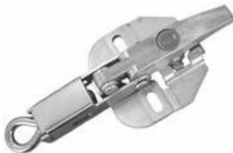
这款简单的杠杆操作式压缩式挂锁提供一个安全的过中心动作，弹簧负载的环首钩让张力集中起来，消除面板的咔哒声，保证面板的安全。设计的锁和保持器安装于同一水平的表面上，向下折叠拉杆，与同轴面板紧密配合。
