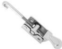
这款成本效益高的轻型杠杆操作压缩式挂锁提供一个安全的过中心动作，消除面板的咔哒声，保证面板的安全。设计的锁和保持器安装于同一水平的表面上，向下折叠拉杆，与同轴面板紧密配合。
